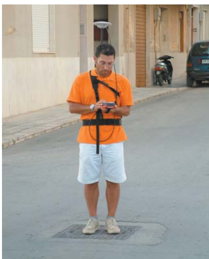
Rilievo in campagna con palmare GPS
